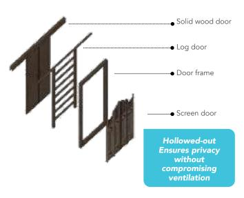
Figure 17 // STRUCTURE OF A TANGLONG DOOR
