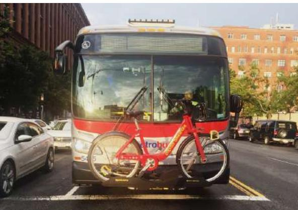
**Figura 47.** Bicicleta transportada en el bus mediante el uso de un rack. Washington DC.
